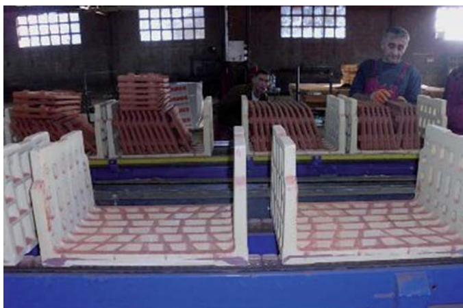
Slika 5: Stari način klasiranja pečenog crepa
